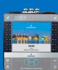
振動分析計 (AMS2140) による低速回転機械・軸受類の定期保全（予知保全）の実施
