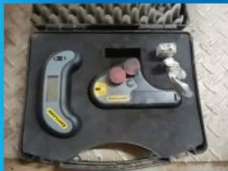
イーザーレーザーによる伝動機器の調芯
