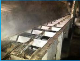
チェーンコンベヤ 概寸: 400×6000L
