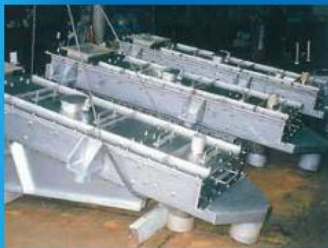
振動篩機 概寸: \Phi 1000 \times 60\text{mesh} 2基
