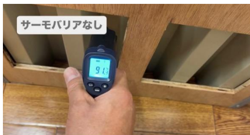
サーモバリアなしの場合約 91 度
