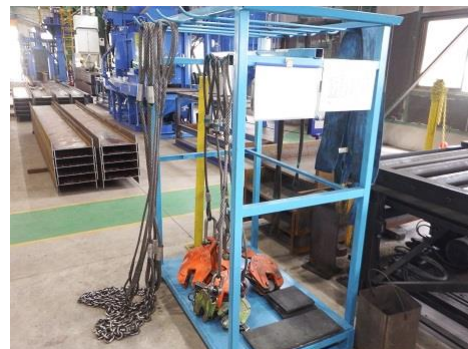
残材で製作した「吊具整理ラック」
