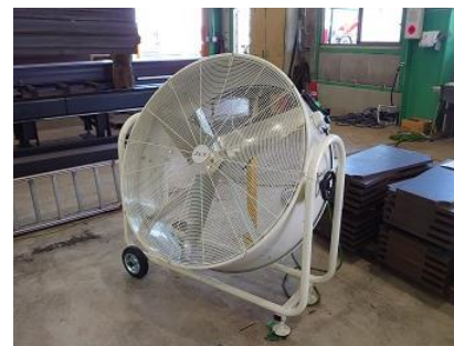
工場内に空気の流れをつくる大型工場扇
