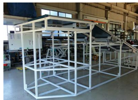
コンベア架台
