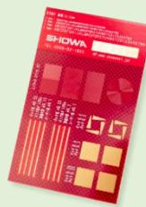
大容量かつ高速データ通信の需要増加に伴い、同社では低誘電率・低伝送損失材料である【MEGTRON6】の常備在庫保有や【テフロン基板】の短納期製造対応を実施。また、インピーダンスコントロールの要望も数多くある。同社では、顧客から要求される様々なインピーダンスコントロールに対してシミュレーション及びテストクーポンを用いての TDR 測定を実施し、より良い製品をスピーディかつ確実な納期で提供している。
