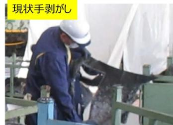
また、リサイクル活用のために従業員がフェルトとシートを手で剥がしている工程について、自動化装置の導入を検討している。これにより、大幅な負荷軽減が期待できる。
