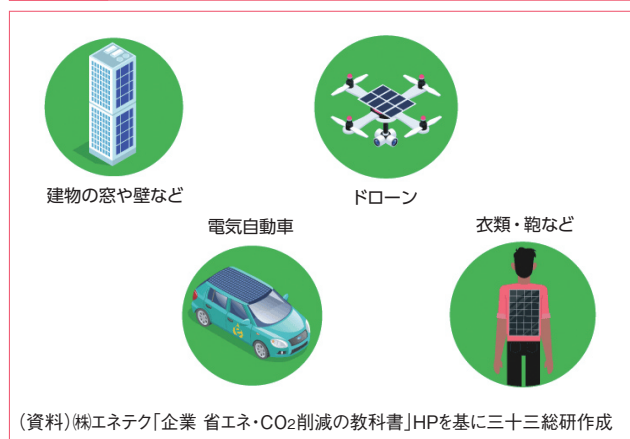
図表1 ペロブスカイト型太陽電池の想定設置場所
